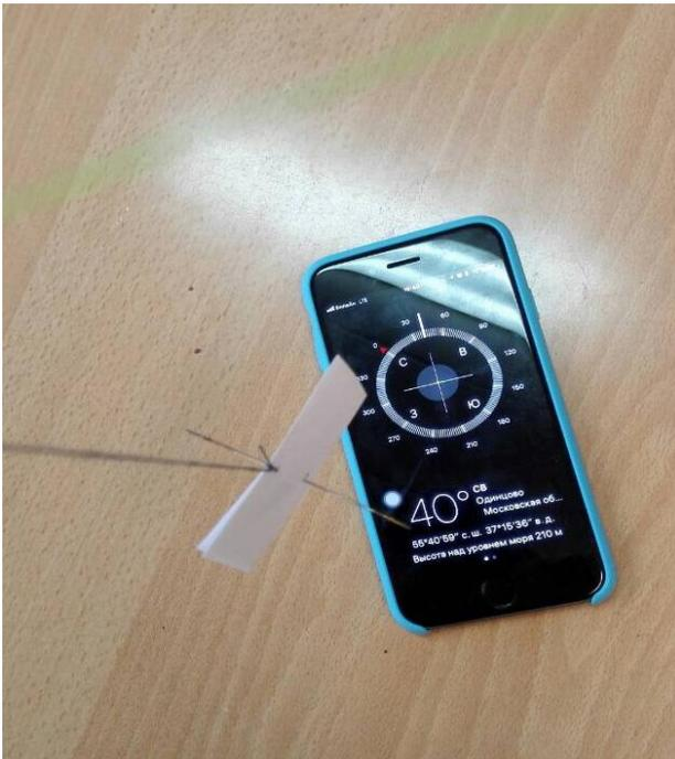
Рис. 1. Намагниченный конец иглки показывает на север.
