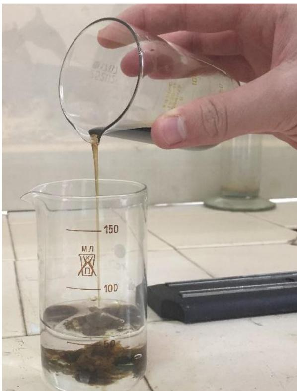
Рис. 7 Налили тонкой струей фильтрат в стакан с избытком раствора аммиака
